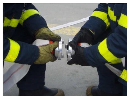
Spojování a rozpojování hadic B
